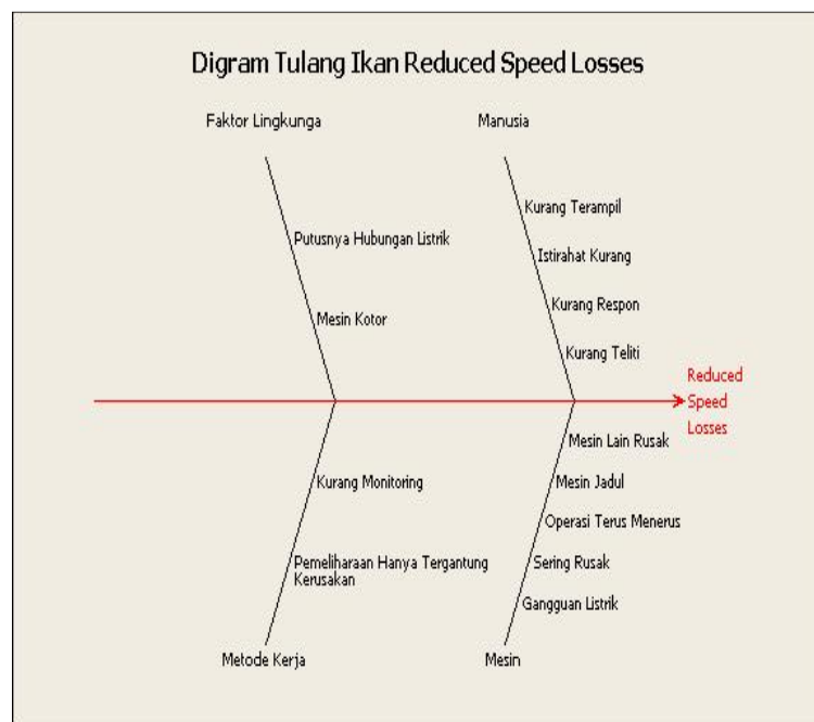
Gambar 6. Diagram Tulang Ikan untuk Reduced Speed Losses
