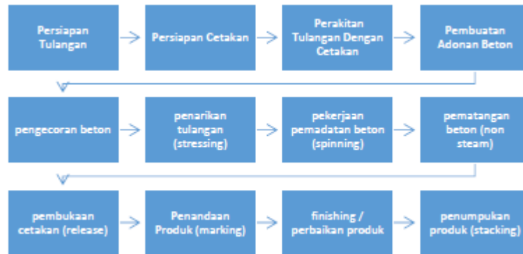
Gambar 3. Alur proses pembuatan tiang pancang
