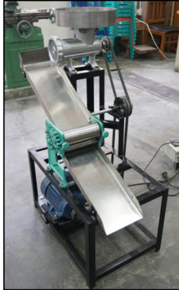
Gambar 4. Prototipe Alat Penggilingan dan Penipisan Karak
