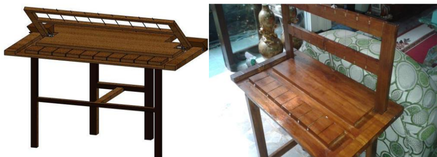
Gambar 6. Gambar Desain 3D dan Prototipe Alat Pemotong Karak
