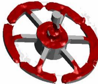
Gambar 6. Simulasi Aliran Cairan Logam Masuk ke dalam Cetakan
