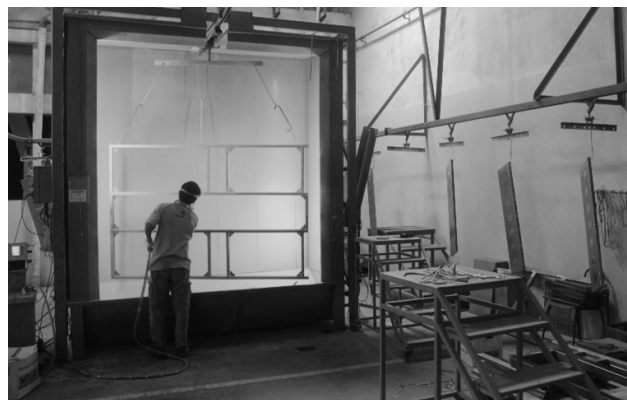
Gambar 2. Proses pengecatan dengan metode powder coating
