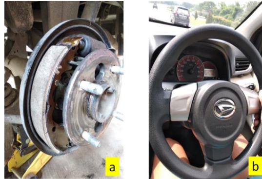
Gambar 6. (a) Pemasangan Rem Sepatu Remanufaktur Pada Kendaraan Uji, (b) Uji Kecepatan Maksimum (120 Km/Jam)
