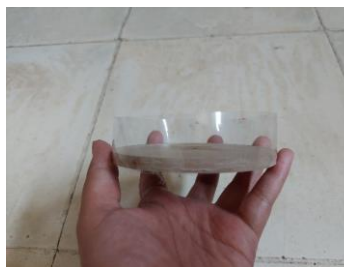
Gambar 9. Assembly Skin dan Sekat Rongga Resonator
