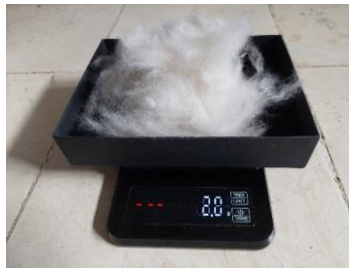
Gambar 4. Pengukuran Berat Filler Serat Kapuk Randu
