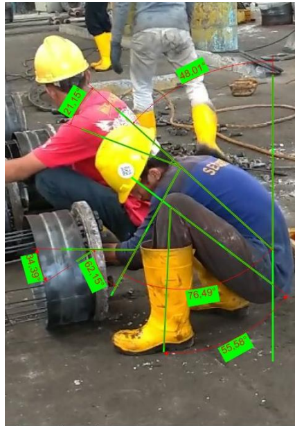
Gambar 3 Penarikan Sudut Postur Kerja Pemasangan Baut
