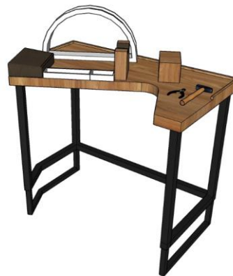
Gambar 1. Desain Meja Kerja Pemasangan Kawat Fret
