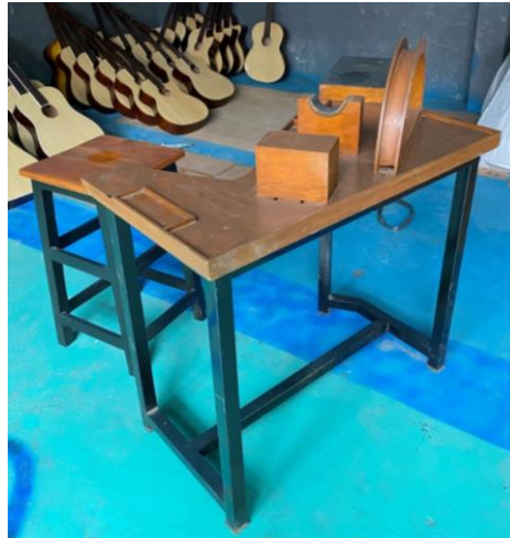
Gambar 2. Realisasi Meja Kerja Pemasangan Kawat Fret
