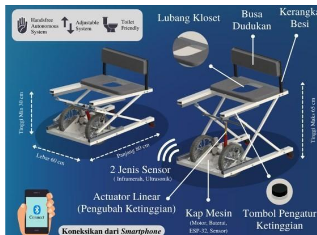
Gambar 3. Mekanisme produk kursi roda (Sumber: Data yang diolah, 2022)
