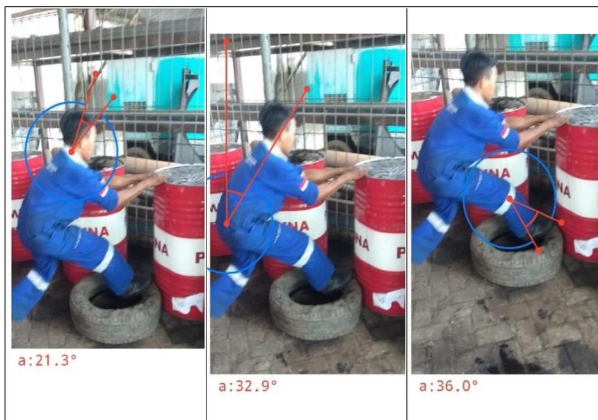
**Gambar 2.** Sudut Pengukuran REBA Kegiatan Mengambil Drum Oli
