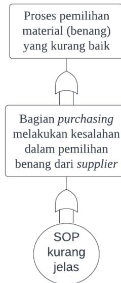
**Gambar 4.** *Fault Tree Analysis* (FTA) Proses Pemilihan Material (Benang) yang Kurang Baik
