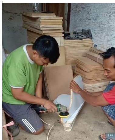
Gambar 1 Proses penghalusan menggunakan gerenda manual
