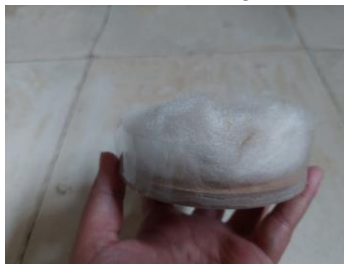
Gambar 10. Memasukkan Filler ke Sekat Rongga Resonator
