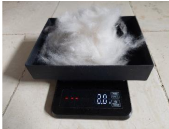
Gambar 4. Pengukuran Berat Filler Serat Kapuk Randu
