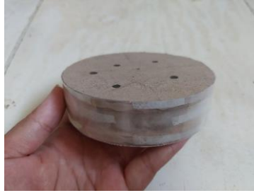
Gambar 11. Assembly Spesimen Uji Serap Bunyi
