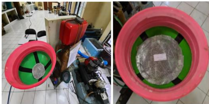
Gambar 2. Kemasan Filter Bentonit Yang Terpasang Di Casing Mesin Bensin TD110
