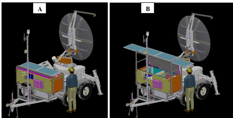
**Gambar 6.** Desain Solar panel pada *SSR*, A. folding B. open
