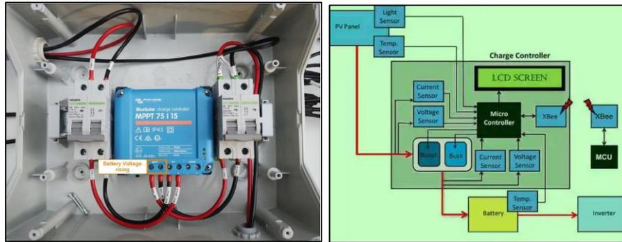
Gambar 7. Diagram MPPT Mikrokontroler, (elprocus.com, 2024)
