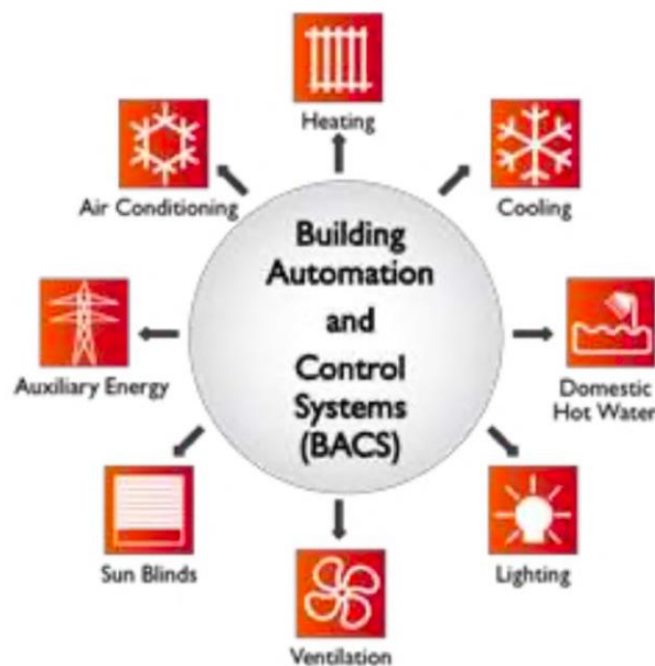
Gambar 5 Skema BAS & BACS. Sumber: Zaini (2015)
