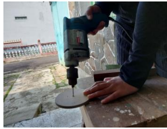
Gambar 7. Pembuatan Lubang Pada Skin Resonator Bagian Atas
