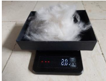
Gambar 4. Pengukuran Berat Filler Serat Kapuk Randu
